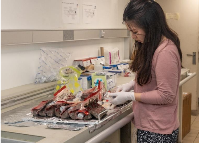
図4 船上にて海洋堆積物から間隙水を抽出している様子 (Interstitial water extraction by rhizon)
