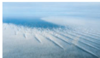
大規模洋上風力発電所の風車後流
