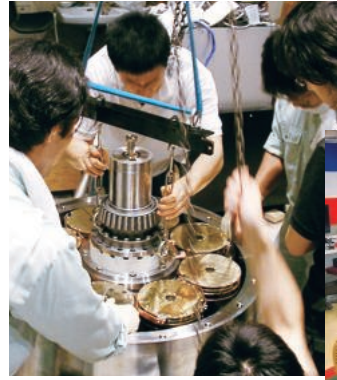
超電導回転機の発電試験
